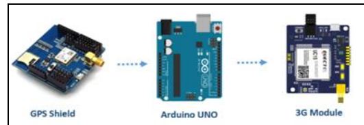
รูปที่ 1 ฮาร์ดแวร์ (GPS Shield, Aduino และ 3G Module) เพื่อการกำหนดตำแหน่งโลก
