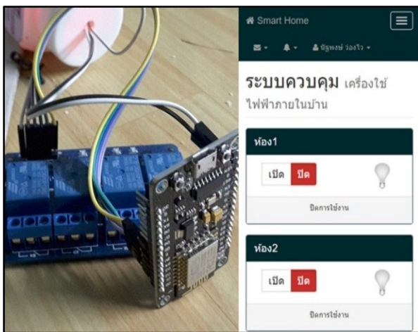
รูปที่ 5 ฮาร์ดแวร์และซอฟต์แวร์ ระบบควบคุมเครื่องใช้ไฟฟ้าภายในบ้าน
